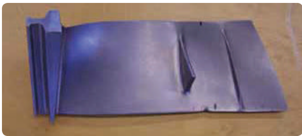
Figure 21-8. Fan blade damage.
