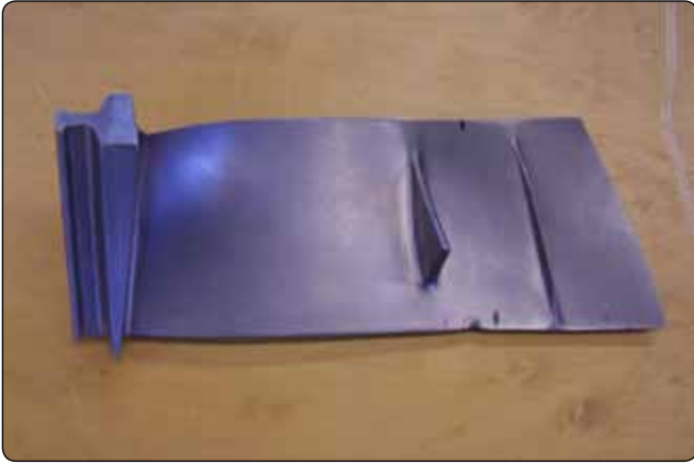
Figure 10-59. Fan blade damage.
